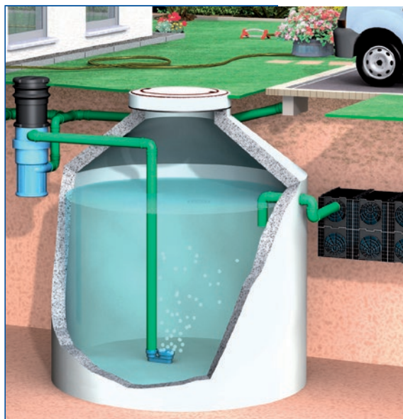
Återvinning av regnvatten. Renat vatten samlas i tank. Överfyllnadsskyddet leder det till infiltration.
