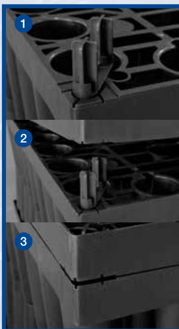
Låsplugg, Dubbel resp Enkel. För installation av kassetter i höjd resp längsled.
